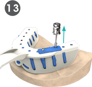
Dévisage des vis des transferts avant la désinsertion du porte-empreinte.
