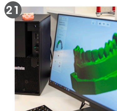
Conception assistée par ordinateur (CAO) d'une armature Zircone.
