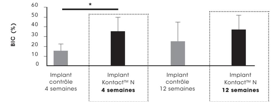
Pourcentage de contact os / implant (BIC) du groupe contrôle versus groupe test à 4 et 12 semaines (\*  $p < 0,05$ ).
