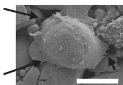
(c) Fort grossissement : ostéoblastes sur la surface nanostructurée en Titane Ti6Al4V
