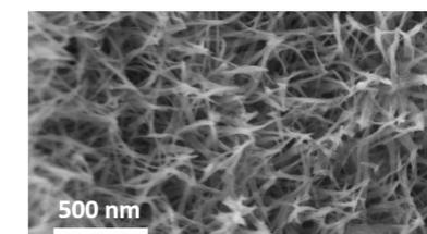
État de surface de l'implant Contact™ N présentant des nanostructures (Microscopie Electronique à Balayage)<sup>2</sup>.
