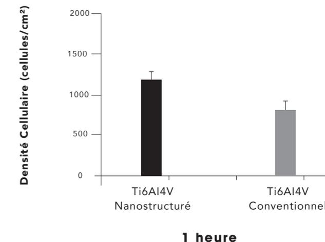
Augmentation de l'adhésion des ostéoblastes sur l'état de surface nanostructurée en Titane Ti6Al4V comparé à l'état de surface conventionnelle en Titane Ti6Al4V (temps d'adhésion = 1h). (Webster & al. 2014)<sup>3</sup>.
